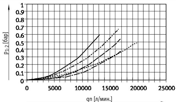
С присоединительной плитой MS12-AGG, Пневматическое подключение G1¼
