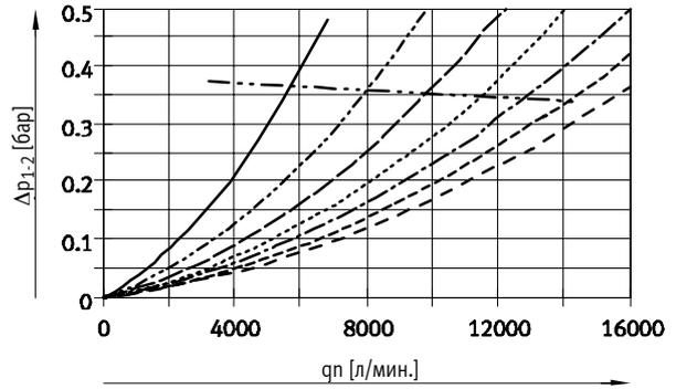
Степень фильтрации 1  $\mu\text{m}$
