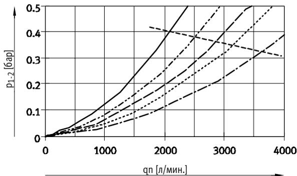
MS6-LFM-3/8-...-HF, степень фильтрации 1  $\mu\text{m}$
