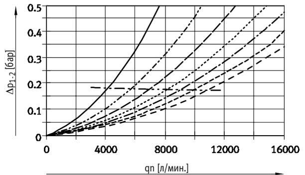
Степень фильтрации 1  $\mu\text{m}$
