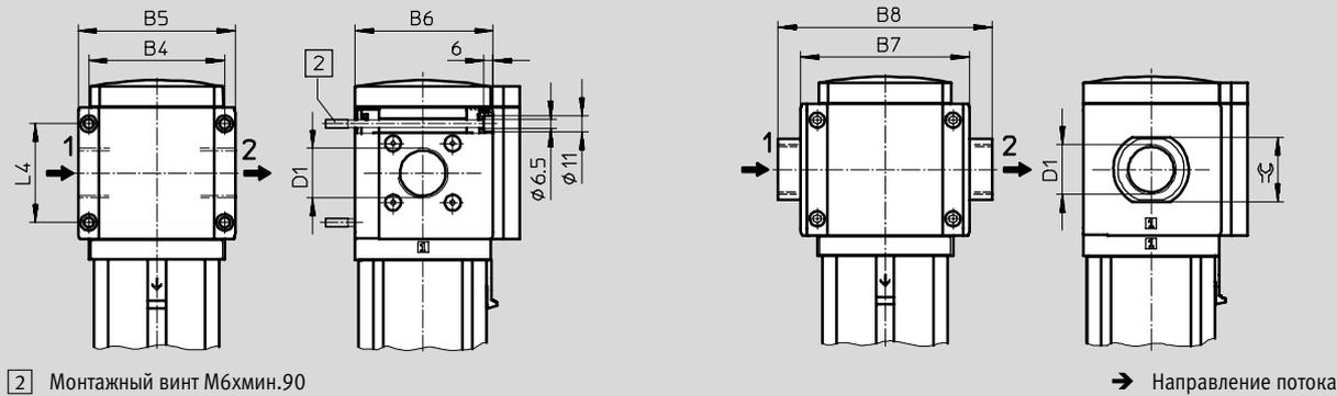
2 Монтажный винт М6хмин.90 по DIN 912 (не входит в состав поставки) для настенного монтажа без использования монтажного кронштейна
