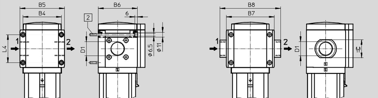
2 Монтажный винт М6хмин.90 по DIN 912 (не входит в состав поставки) для настенного монтажа без использования монтажного кронштейна
