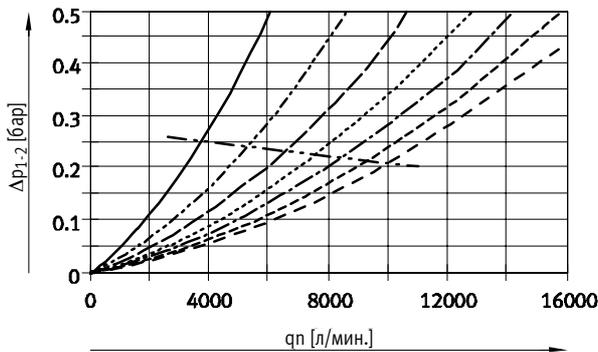
Степень фильтрации 0.01  $\mu\text{m}$
